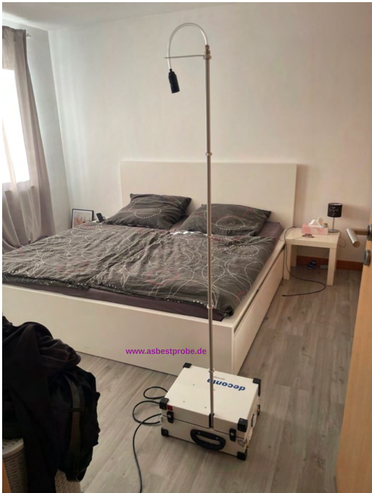
Abbildung 15: Status quo Messung, es liegen beschädigte asbesthaltige Bodenfliesen unter dem Laminat
